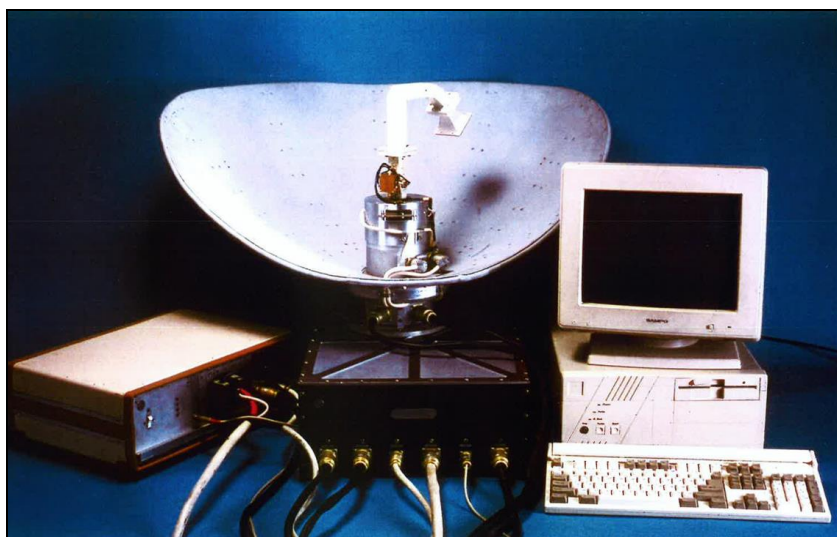
Фиг. 6. Технологичен образец на Сканиращата двуполяризационна радиометрична система Р-400 и Контролно-измервателната апаратура (КИА) към нея
